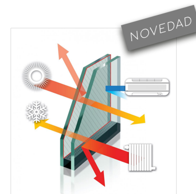
Cortina de vidrio con doble acristalamiento.
